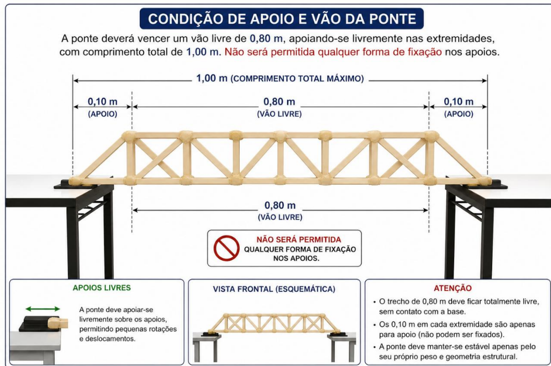
Figura 4 – Condição de apoio da ponte
